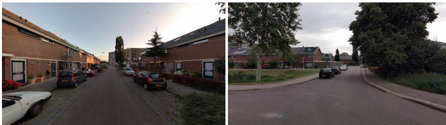
afbeelding 5.1 Links: Van Lodensteinstraat (deel met noord-zuidoriëntatie) in huidige situatie met parkeervakken van ca. 2,30 meter breed. Rechts: Van Lodensteinstraat (deel met oost-westoriëntatie t.h.v. Bootsmastraat) in huidige situatie met parkeren op de rijbaan.
